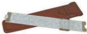
4. Regla de cálculo, dispositivo manual inventado para facilitar la realización de multiplicaciones y divisiones.
