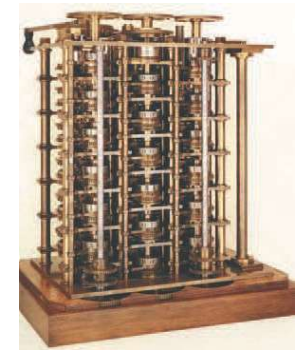
6. Charles Babbage anticipó con bastante precisión el diseño de una computadora, pero las limitaciones técnicas le impidieron construirla. Ésta es la máquina de las diferencias.
