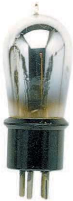
8. Los principales componentes de la primera computadora fueron los bulbos.
